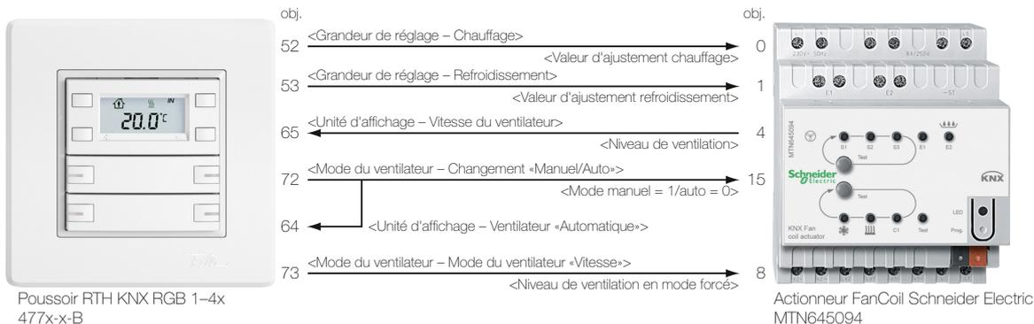
Pour la bonne coopération entre le thermostat d'ambiance et l'actionneur FanCoil Schneider Electric, les paramètres suivants doivent être utilisés:
