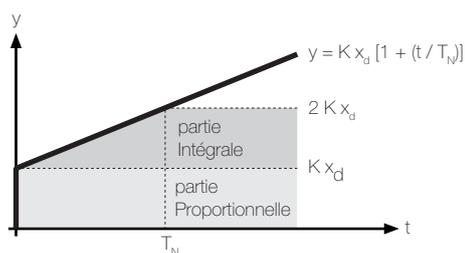
Algorithme de régulation PI: Grandeur de réglage
