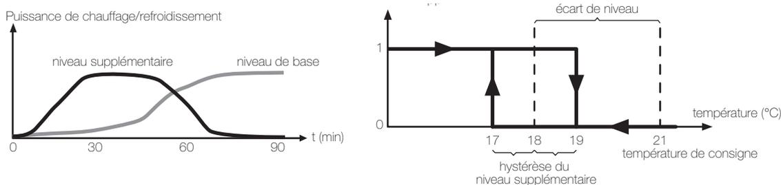
Le niveau supplémentaire à commande via un réglage à deux points (→ [chapitre 3.6.3](#)) reste enclenché jusqu'à ce qu'il atteigne l'écart de niveau défini de la température de consigne (paramètre **Écart de niveau entre le niveau de base et le niveau supplémentaire** → [chapitre 2.6.2](#)) plus hystérèse (paramètre **Hystérèse du niveau supplémentaire**). Le niveau supplémentaire est alors arrêté et seul le niveau de base est enclenché.
